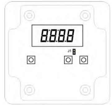
**Achtung: Nach der Konfiguration den Jumper J1 wieder in ‚Parkposition‘ aufstecken (nur ein Kontakt angesteckt, einer hängt in der Luft)!**
