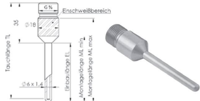
Zylindrische Einschweißhülse auf Gewinde G 3/8", zum Einbau in eine bestehende Klemmringverschraubung (GKEV-25/76 oder GEMK-25/76) oder zum Einschweißen in Rohre und Behälter.
