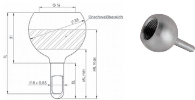
Kugelschweißhülse auf Gewinde G 1/2" Standard, zum Einbau in Rohrbögen und Behälter.
