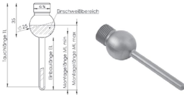
Kugeleinschweißhülse auf Gewinde G 3/8", zum Einbau in Rohrbögen und Behälter.
