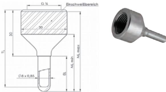
Zylindrische Einschweißhülse auf Gewinde G 1/2" Standard, zum Einbau in Rohre und Behälter.
