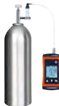
Kalibrierung an Prüfgas
