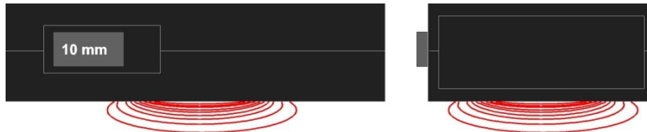
Seitenansicht: Messfeld und Eindringtiefe bei Schalterstellung „10 mm“
