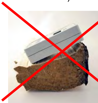
Falsch: Verworfene Oberfläche (hier extrem!)
