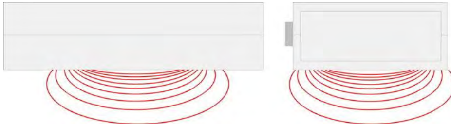
Seitenansicht: Messfeld und Eindringtiefe ca. 25 mm
