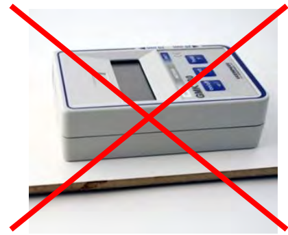
Falsch: zu geringe Materialstärke
