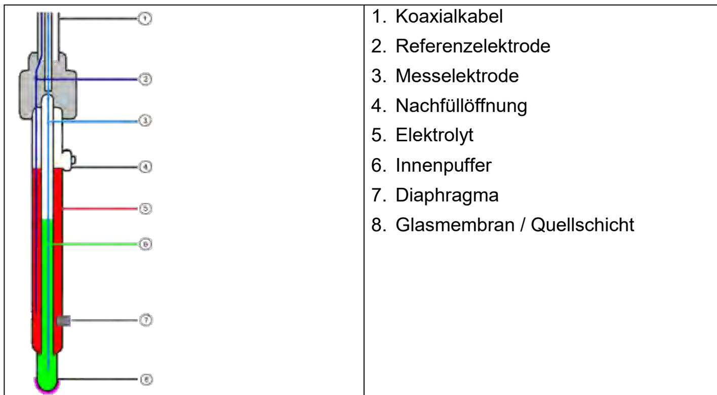
Das Diaphragma kann in unterschiedlicher Art und Weise ausgeführt sein, es bildet eine Verbindung zwischen Elektrolyt und der zu messenden Flüssigkeit. Eine Verstopfung oder Verschmutzung des Diaphragmas ist oft die Ursache für Fehlverhalten und Trägheit der Elektrode. Die Glasmembran ist sehr schonend zu behandeln. Auf
