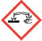
Symbol weist auf Gefahren für lebendes Gewebe, aber auch für viele Materialien hin, die bei Kontakt mit dieser Chemikalie geschädigt oder zerstört werden. Ätzwirkung, Schutzausrüstung erforderlich!
